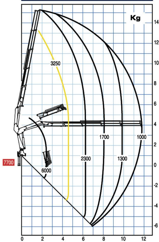
— Portata massima passante per l'orizzontale - Max. capacity from horizontal to vertical - Capacité maxi passant par l'horizontale - Max. Tragkraft von horizontal bis zu vertical - Capacidad máxima en posición vertical
