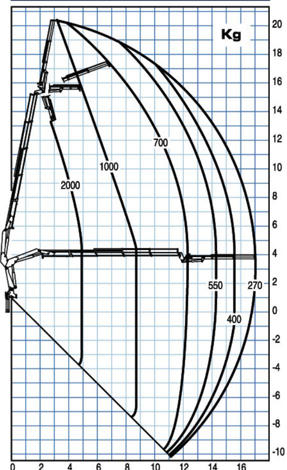
**Abbinamento gru/veicolo - Trucking crane combination - Accouplement grue/véhicule Acoplamiento grúa con vehículo - Kran zusammen mit LKW**
