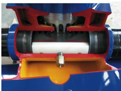
Nuova base con sistema di lubrificazione
