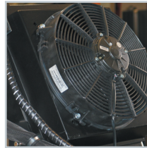
Heat exchanger. Cambiador de calor.
