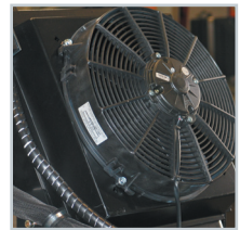
Heat exchanger. Cambiador de calor.
